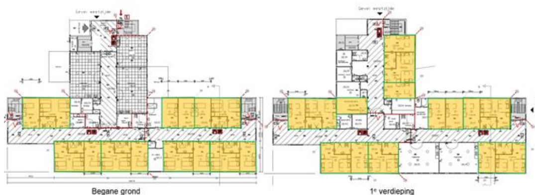
Figuur 3.6 Beschermde subbrandcompartimenten
